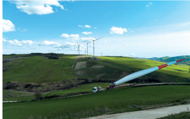
Macht den Transport von langen Rotorblättern auch auf kurvigen Straßen möglich: der Bladelifter.
