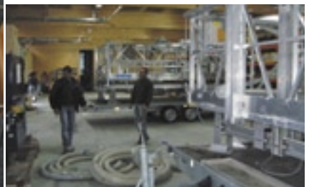
Rotorblattbefahranlagen in der Servicehalle.
