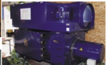
Getriebe einer V 90 im Ersatzteillager.
