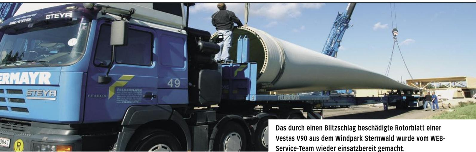
Das durch einen Blitzschlag beschädigte Rotorblatt einer Vestas V90 aus dem Windpark Sternwald wurde vom WEB-Service-Team wieder einsatzbereit gemacht.
