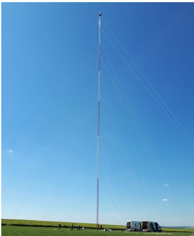
Falls Sie sich schon immer gefragt haben, wie die W.E.B die Windverhältnisse bei der Projektierung eines Windparks misst – hier ein im Mai in Frankreich aufgebauter Windmessmast.
